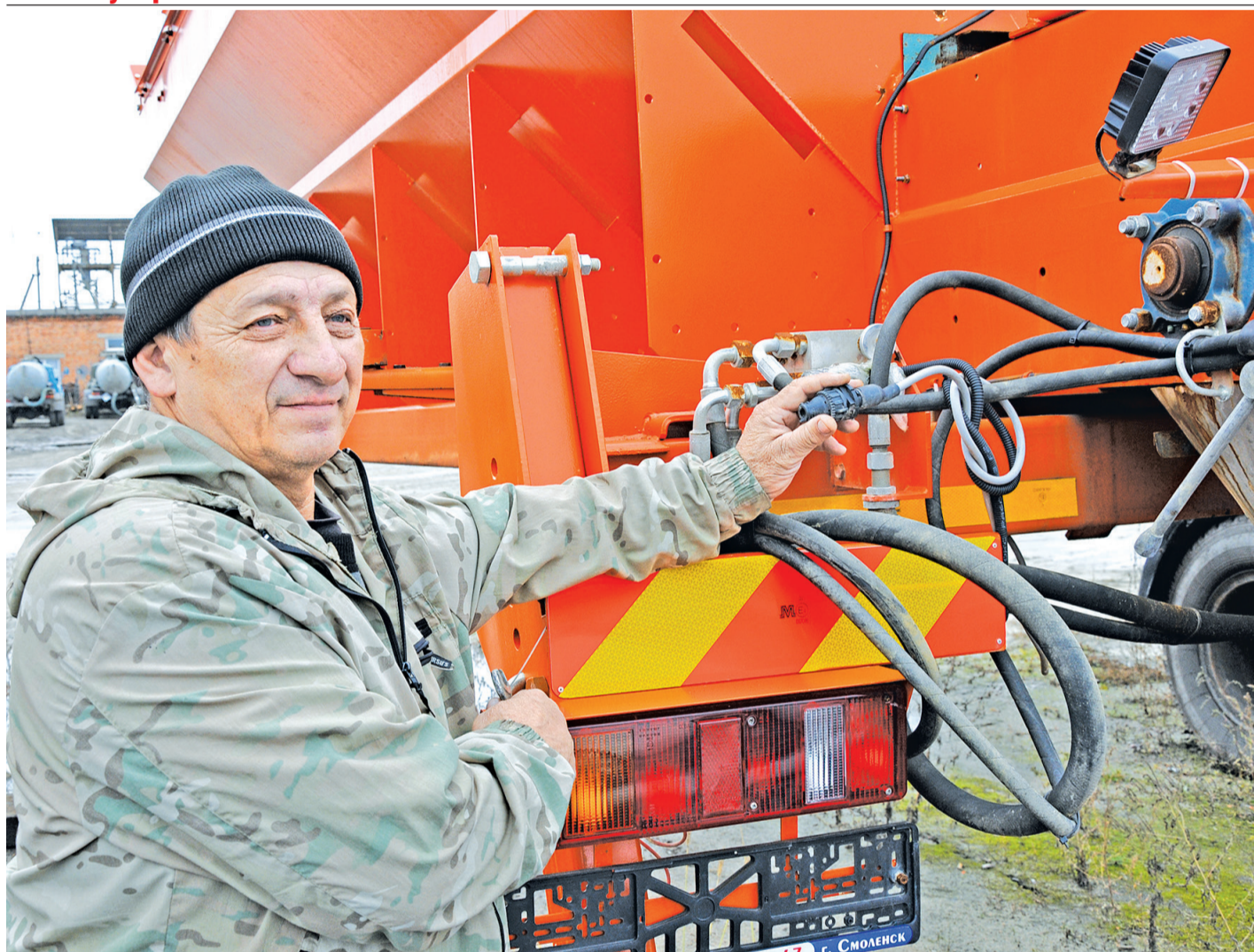
Работник МАУ Борисовского района «Благоустройство» Сергей Алейник проверяет состояние распределителя гидравлической системы КДМ перед установкой её на новое транспортное средство
